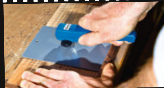
Test mécanique - contrôle de la conformité du laquage
